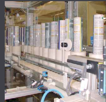
System EL-85 für Transport von Werkstückträgern in Handlings- und Bearbeitungsstationen EL-85 conveying system for pallets in handling and processing stations
