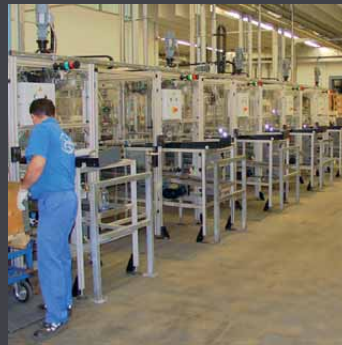
System EL-85 für Transport von Werkstückträgern in Handlings- und Bearbeitungsstationen EL-85 conveying system for pallets in handling and processing stations
